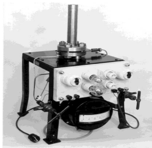
Reaktor zur Erforschung des Ammoniak-Katalysators, 1911
