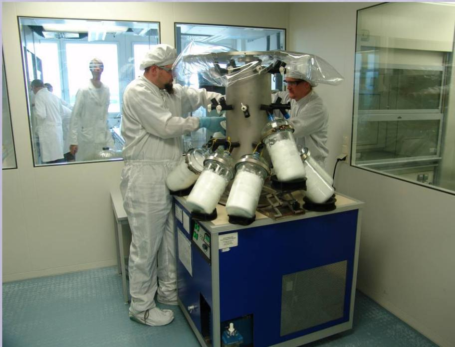
Gefriertrocknung eines Endprodukts im Reinraumbereich
